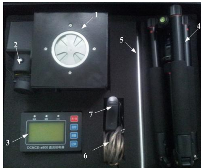
图 1 DCNCE-±800 验电器组成部分
