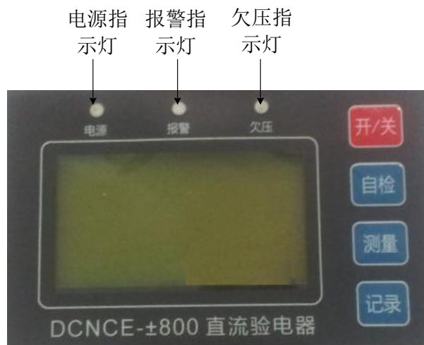
图 2 DCNCE-±800 验电器控制手柄及按钮功能
